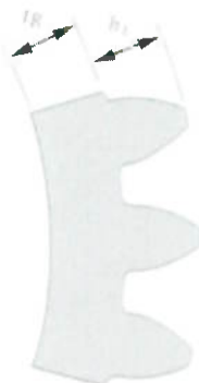
Figura 6 – Parâmetros para o Fator de Espessura de Borda a Flexão (Norton, 2004)
